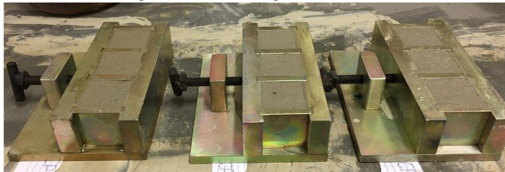
Figura 3.5 - Amostra de argamassa nos moldes
