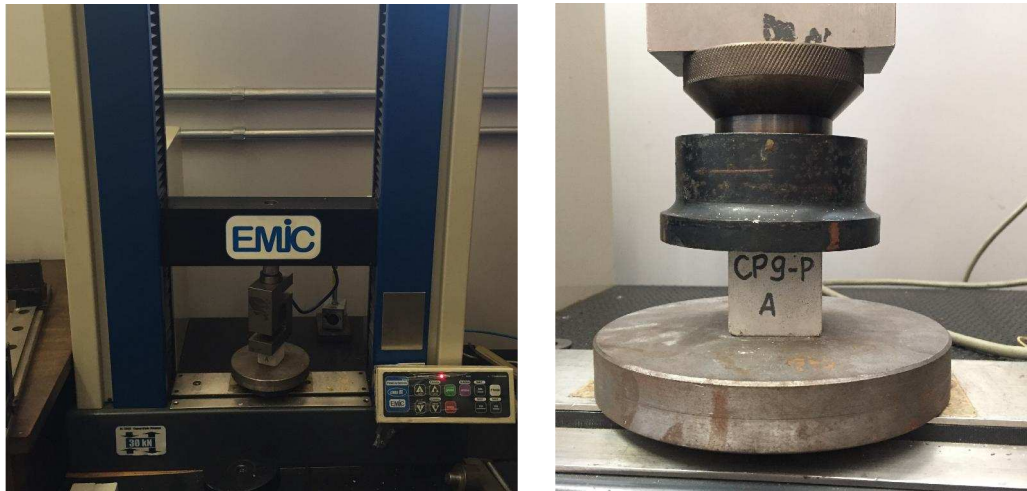
Figura 3.6 - Ensaio de compressão em CPs prismáticos de argamassa
