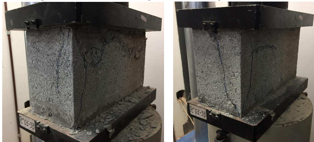
Figura 4.1 - Blocos de concreto após o ensaio de compressão (CPs 3 e 6)
