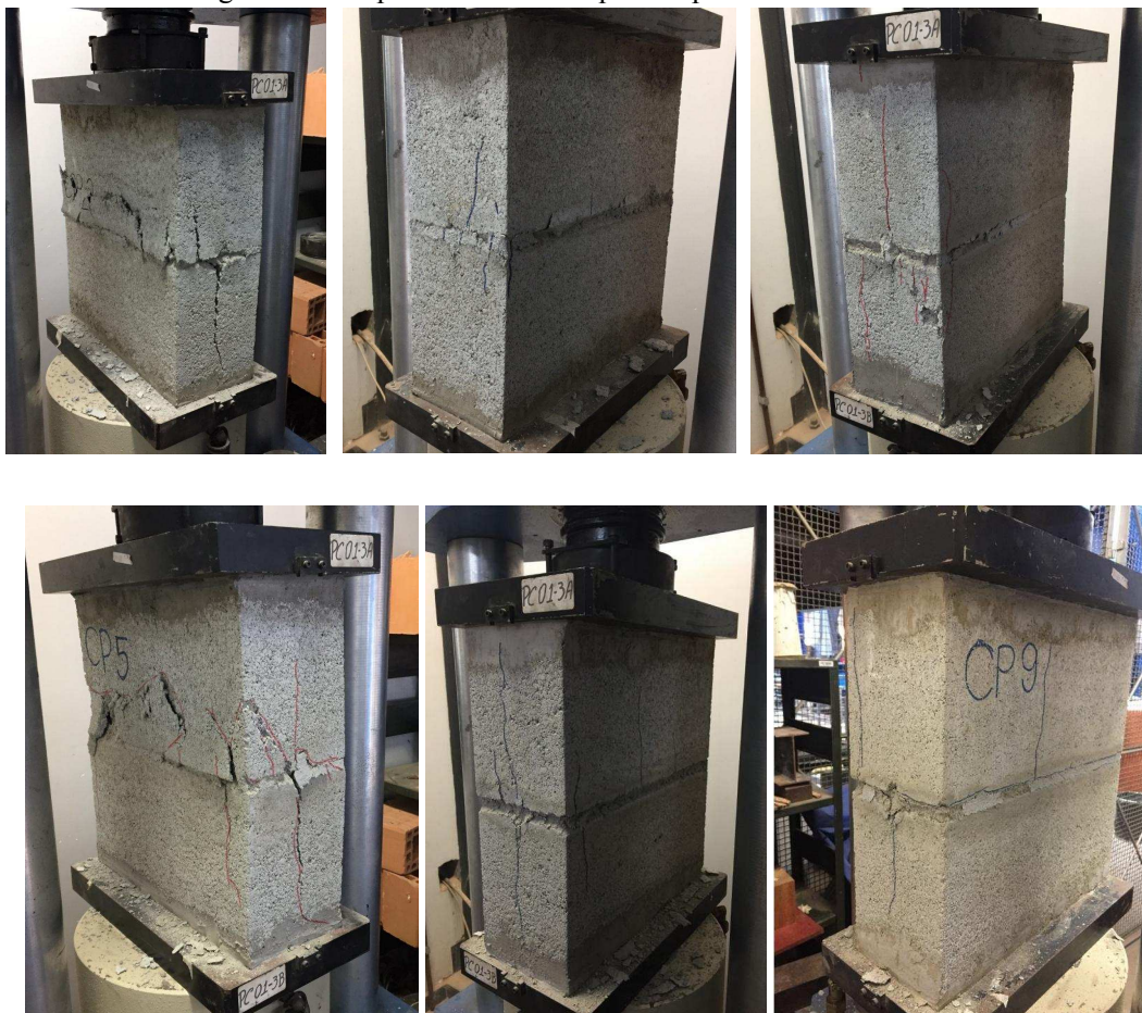
Figura 4.3 - Rupturas observadas para os prismas de dois blocos
