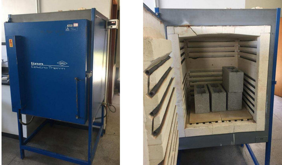
Figura 3.3 - Estufa utilizada na secagem dos blocos
