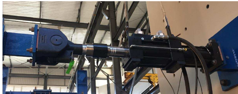
Figura 3.19 - Atuador hidráulico MTS DuraGlide 244.31
