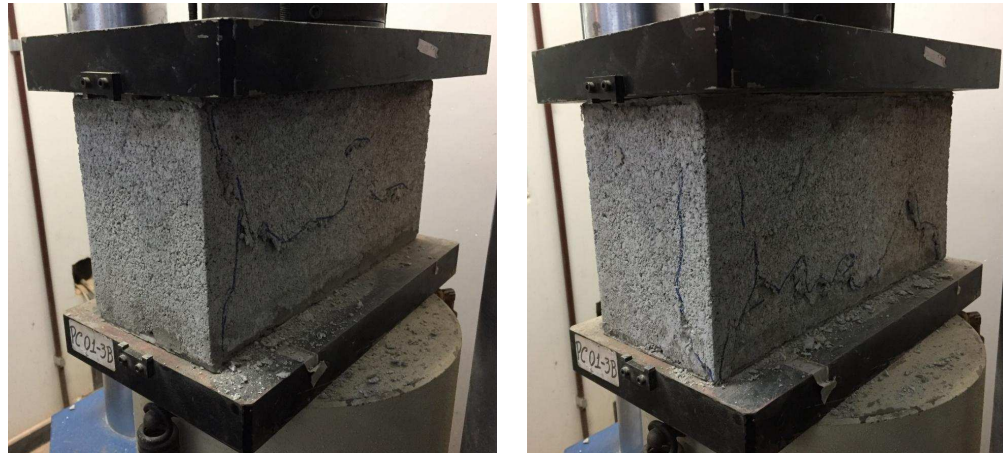
Figura 4.2 - Blocos de concreto após o ensaio de compressão (CPs 7 e 9)
