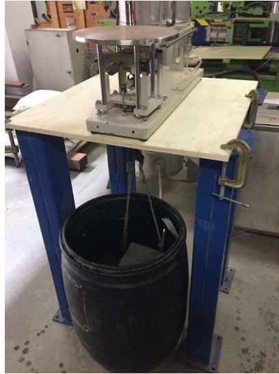
Figura 3.4 - Montagem para determinação da massa aparente
