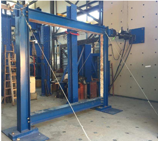
Figura 3.15 - Sistema de travamento fora do plano por meio de cabos metálicos
