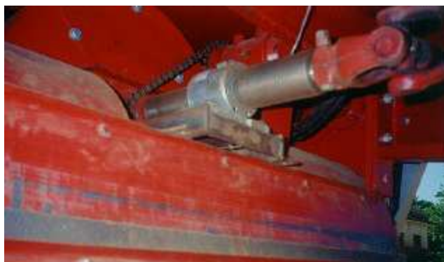
Figura 2. Local de instalação do torquímetro na colhedora
