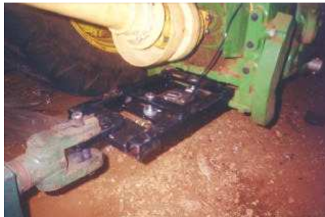
Figura 4. Anteparo e célula de carga colocados entre trator e máquina
