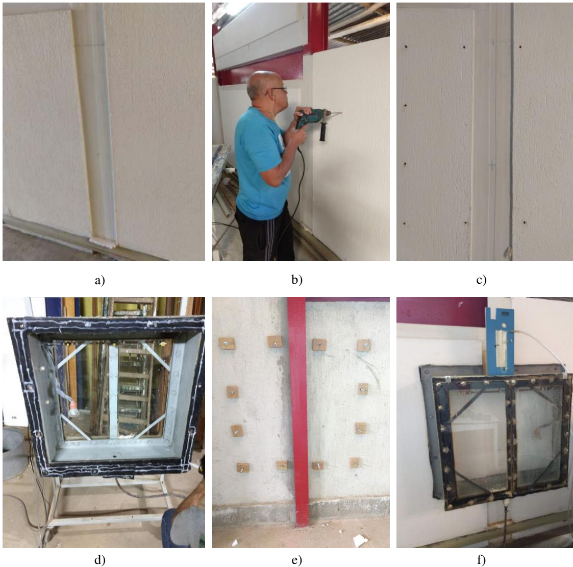
Figura 60 - Sequência de fixação da câmara de estanqueidade: a) aspecto da parede sem furos; b) furação da parede com brocas de vídea; c) aspecto da parede com furos; d) aplicação de silicone; e) ajuste dos tarugos na face interna; f) posicionamento final da câmara para realização do ensaio.
