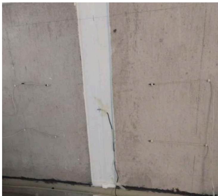
Figura 50 – Posicionamento e fixação de termopares.
