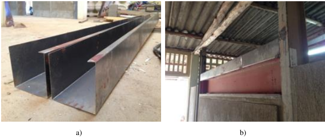
Figura 28 – Elementos utilizados para simular a disposição de uma laje sobre a viga do pórtico: a) chapa galvanizada dobrada; b) chapa soldada sobre a viga.
