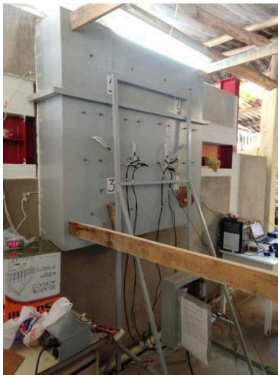
Figura 56 - Painel radiante posicionado e preparado para o início do ensaio na interface INT2.
