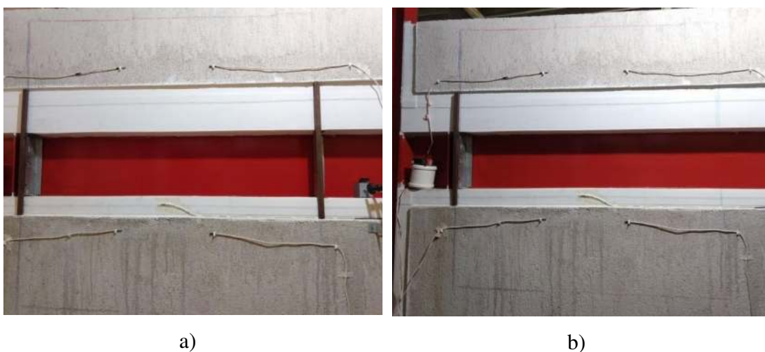
Figura 92 - Aspecto da interface INT2-JH1/JH3-E2: a) antes do ensaio de exposição à ação do calor e choque térmico; b) após a execução do ensaio de exposição à ação do calor e choque térmico.
