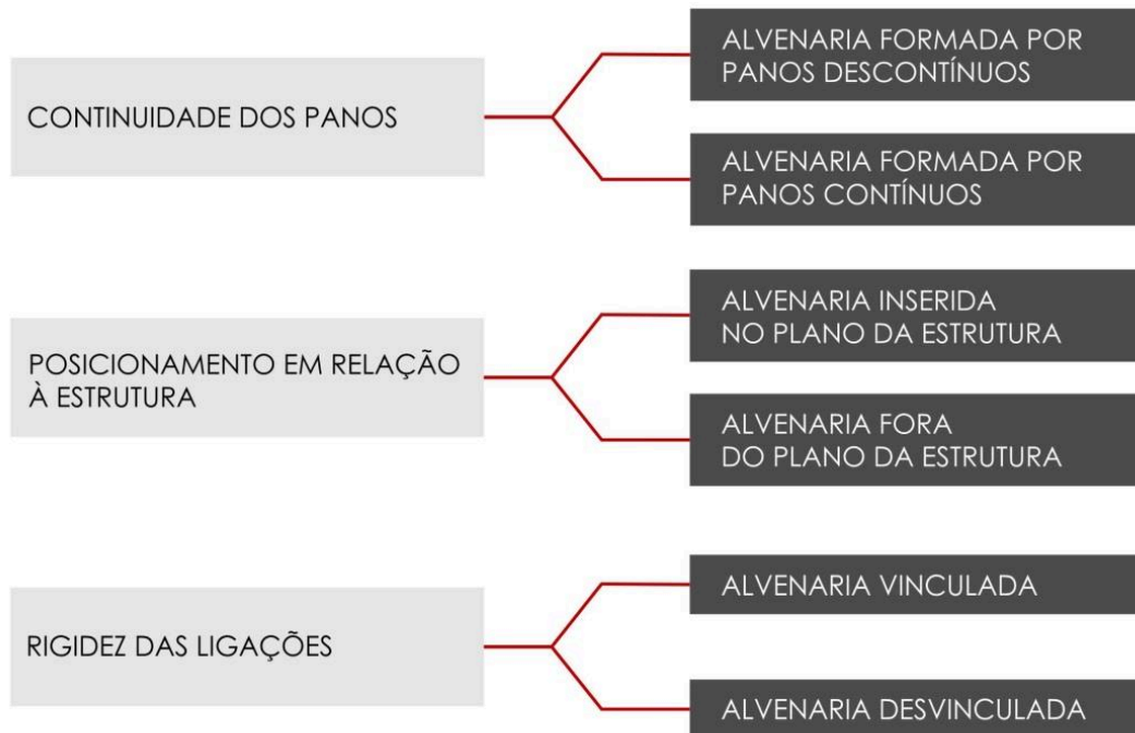
Figura 5 - Classificação das alvenarias segundo os parâmetros de rigidez das ligações, posicionamento em relação à estrutura e continuidade dos panos.
