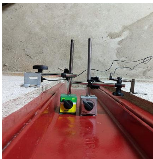
Figura 44 - Fixação dos DTs com o uso de base magnética.
