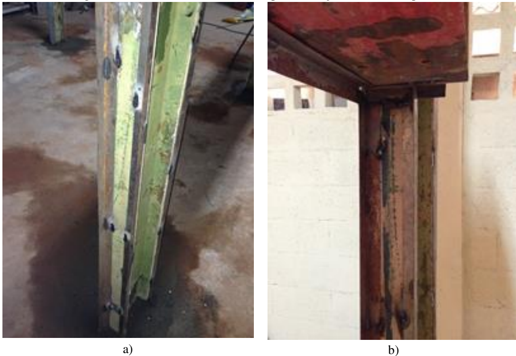
Figura 22 – Cantoneiras soldadas nos perfis de aço do modelo experimental.
