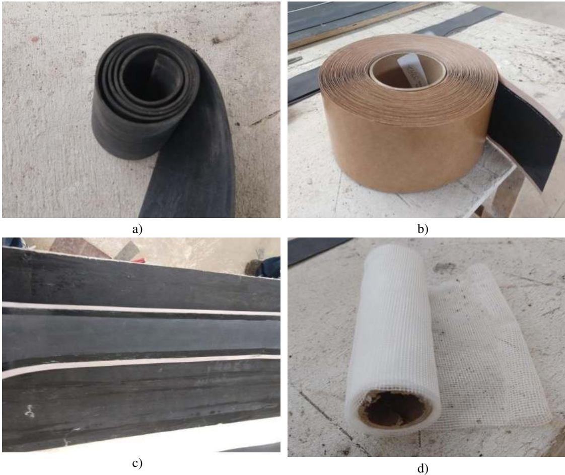
Figura 11 – Materiais utilizados na aplicação do tratamento com manta de elastômero EPDM: a) manta de elastômero EPDM; b) fita de caldeação; c) manta de elastômero EPDM aderida à fita de caldeação; d) tela de poliéster.
