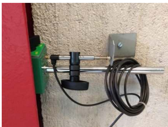
Figura 43 - Transdutor de deslocamento.
