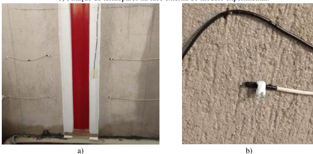
Figura 48 – a) Marcação do perímetro do ensaio de exposição à ação do calor e choque térmico; b) Fixação de termopares na face externa do modelo experimental.
