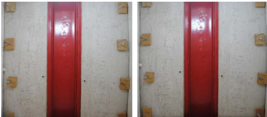
Figura 114 - Aspecto da face interna do modelo experimental, na interface INT3-JV1-E2, durante o ensaio de estanqueidade à água.
