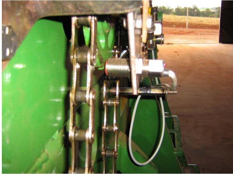
Figura 16 – Vista lateral da disposição do sensor utilizado para determinar a patinação dos rodados-motriz da semeadora-adubadora.
