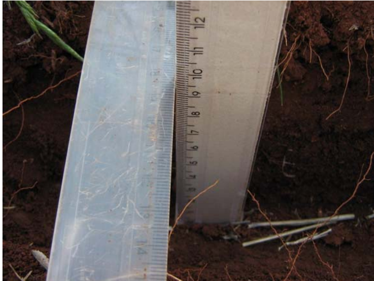
Figura 6 – Determinação da profundidade do sulco de semeadura.
