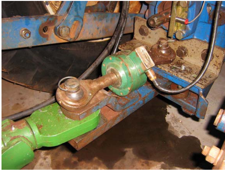
Figura 9 – Vista geral da montagem para a medição da força de tração.
