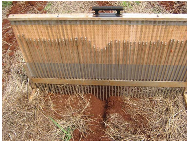
Figura 7 – Perfilômetro utilizado para determinação da área mobilizada.
