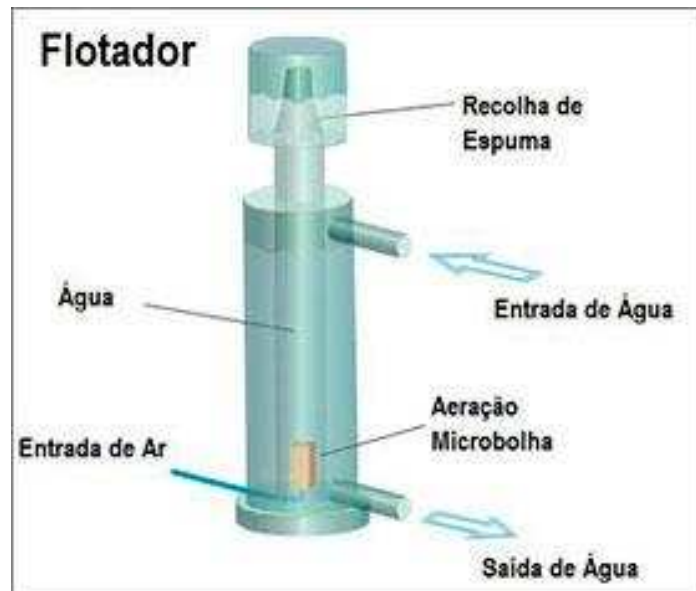
Figura 2 - Desenho esquemático de um flotador.
