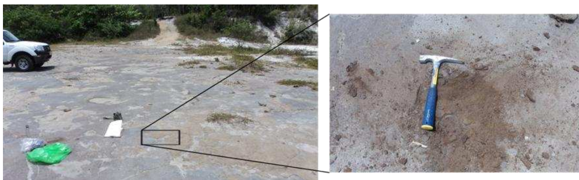
Figura 14 – Camada endurecida de origem pedogenética (Ortstein) em área de ocorrência de Espodossolos do perfil P4 desenvolvido sobre os sedimentos Pós-Barreiras.
