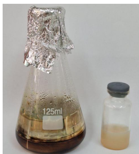
Figura 26. Erlenmeyer com formação de crosta de prata e vidro de penicilina contendo alíquota da amostra de AgNP aquecida a 90 °C.
