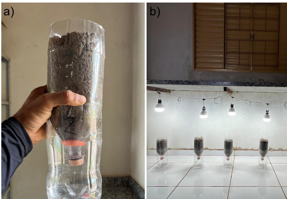
Figura 3 - Extrator de Berlese-Tullgreen (adaptado). Estrutura do Extrator (2a). Processo de extração (2b).
