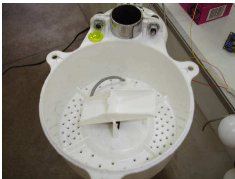
Figura 13 - Sensor de precipitação pluvial com o reservatório basculante.
