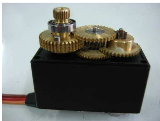
Figura 17 - Micro servo-motor com detalhes das engrenagens.
