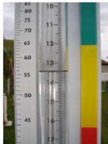
Figura 4 - Irrigâmetro indicando o momento de irrigar (nível da água no tubo de alimentação na direção da faixa amarela), a lâmina evapotranspirada (13,4 mm) e a velocidade de rotação (56%) do pivô central.
