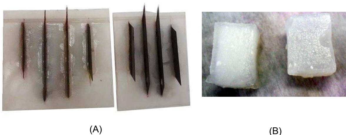
Figura 47 – (A) Dispositivos home-made utilizados para o corte dos pellets de ágar-ágar, espaçamento de 2,0 cm e espaçamento de 1,5 cm. (B) Pellets obtidos após corte da matriz de ágar-ágar utilizando dispositivos home-made.
