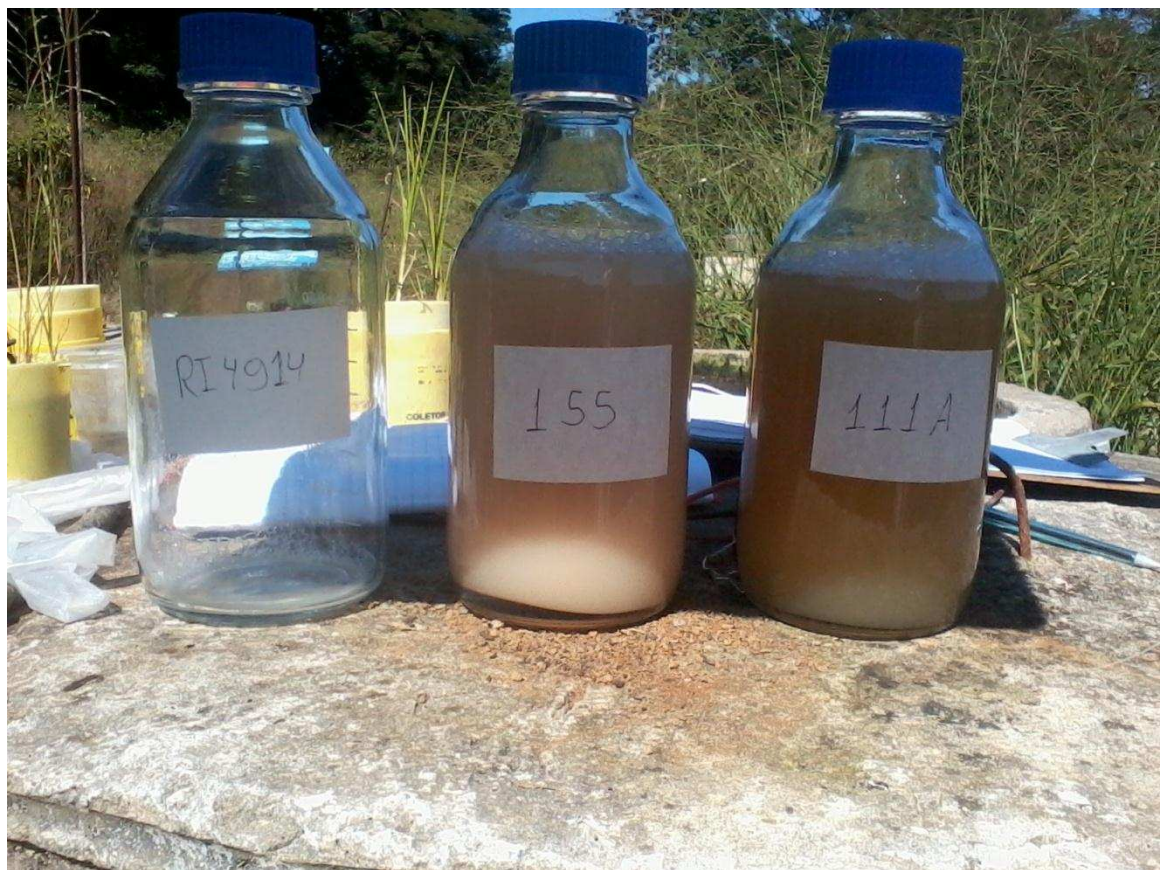
Figura 9 – Frascos com diferentes cepas da bactéria utilizadas no experimento para desobstrução do sistema de gotejadores, colônia “111 A” aplicada na plataforma 1, colônia “155” aplicada na plataforma 2 e colônia ”RI 4914” aplicada na plataforma 3.
