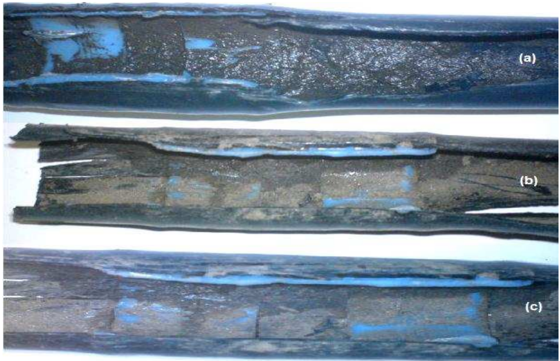
Figura 19 - Gotejadores demonstrando o acúmulo de biofilme e sedimentos no seu interior. (a) gotejador na plataforma 1; (b) gotejador na plataforma 2; (c) gotejador na plataforma 3.
