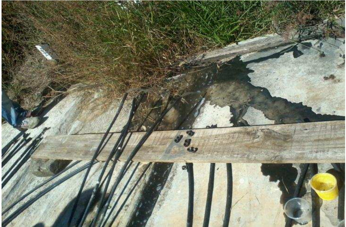
Figura 11 - Linhas laterais abertas (L1, L2, L3 e L4) para garantir o contato de todos os gotejadores com as três cepas da bactéria que foram inoculadas.
