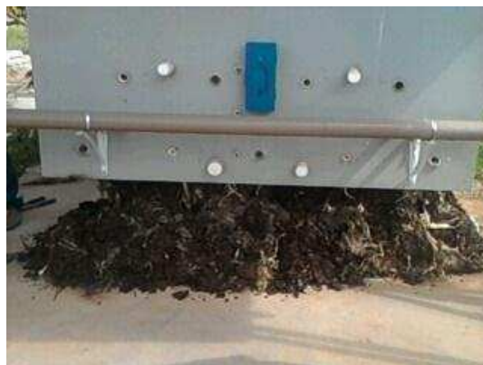
Figura 21. Sistema de descarga do protótipo.
