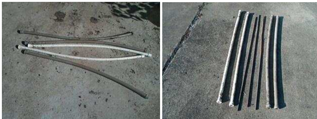
Figura 24. Lanças de aeração sem vara de aço e com varas de aço.
