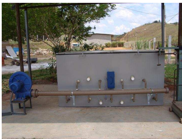
Figura 13. Vista frontal do ventilador conectado as tubulações do protótipo
