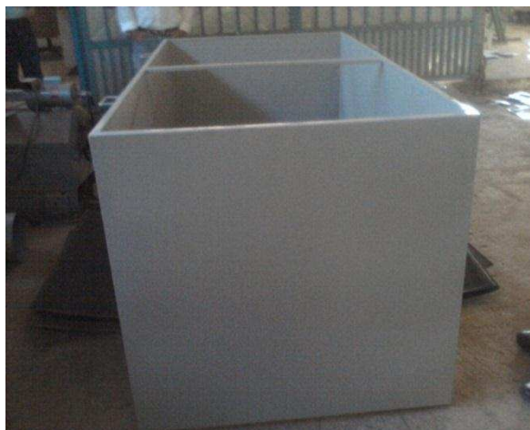
Figura 8. Estrutura metálica do protótipo envolvida por material isolante.
