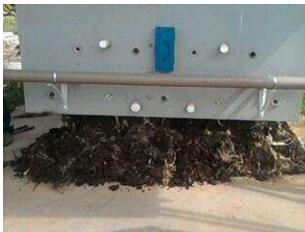
Figura 28. Presença de penas e ossos após a descarga dos resíduos do biodigestor
