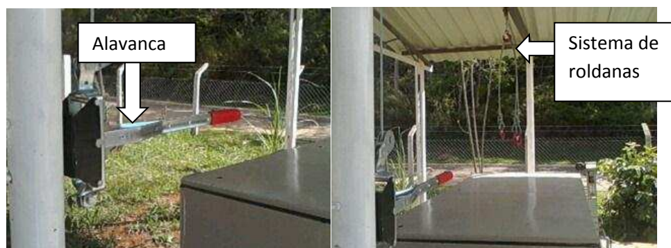
Figura 20. Sistema de descarga do protótipo.
