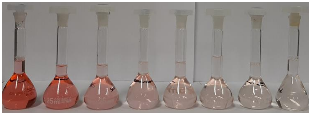
Figura 53: Coloração da solução contendo o extrato puro e na presença de diferentes concentrações de sulfito (0,1 mmol L -1 a 5,0 mmol L -1 ), sendo este aumento representado da esquerda para a direita.
