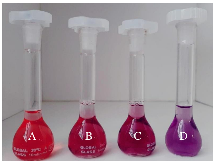
Figura 45: Coloração do extrato de berinjela em diferentes concentrações de ferro (II) (0,4 mmol L -1 a 32 mmol L -1 ), sendo este aumento, da esquerda para a direita. (A) 0,4 mmol L -1 ; (B) 10 mmol L -1 ; (C) 18 mmol L -1 ; (D) 26 mmol L -1 .
