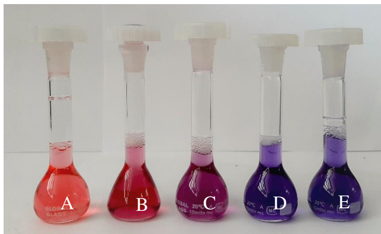
Figura 42: Coloração do extrato de berinjela em diferentes concentrações de alumínio ( 0,4 \text{ mmol L}^{-1} a 4,0 \text{ mmol L}^{-1} ), sendo este aumento, da esquerda para a direita. (A) 0,4 \text{ mmol L}^{-1} ; (B) 0,6 \text{ mmol L}^{-1} ; (C) 1,0 \text{ mmol L}^{-1} ; (D) 2,0 \text{ mmol L}^{-1} ; (E) 4,0 \text{ mmol L}^{-1} .
