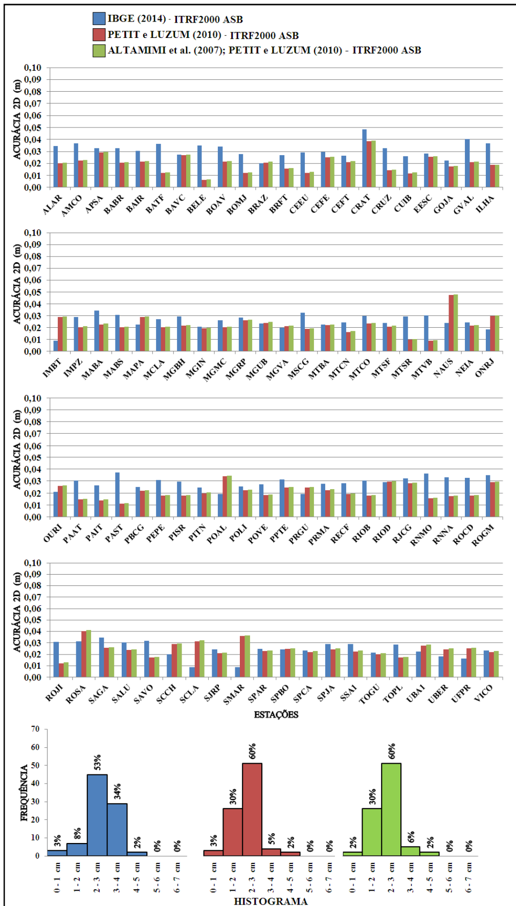
Figura 19: Gráfico de acurácia das estações referente à componente planimetrica para 3 possibilidades de transformação de referencial e atualização de coordenadas, usando o modelo de velocidade ITRF2000 ASB e seus respectivos histogramas de frequência.
