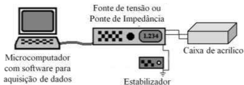
FIGURA 3.5: Esquema do aparato experimental utilizado para a realização das medidas elétricas dc e ac e aquisição de dados. A amostra é colocada dentro da caixa de acrílico descrita na sessão 3.5 e conectada ora à fonte de tensão dc, ora à ponte de impedância. Os dados são adquiridos via placa GPIB acoplada ao microcomputador.
