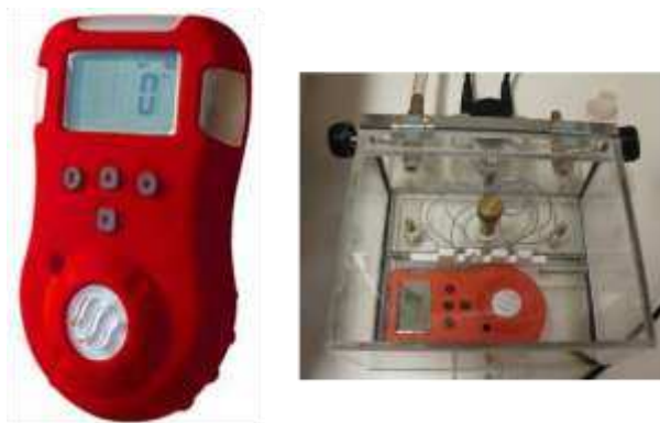
FIGURA 3.4: À esquerda, detector de amônia digital portátil comercial, modelo DG-200, marca Instrutherm. À direita, detector disposto dentro da câmara de gás.
