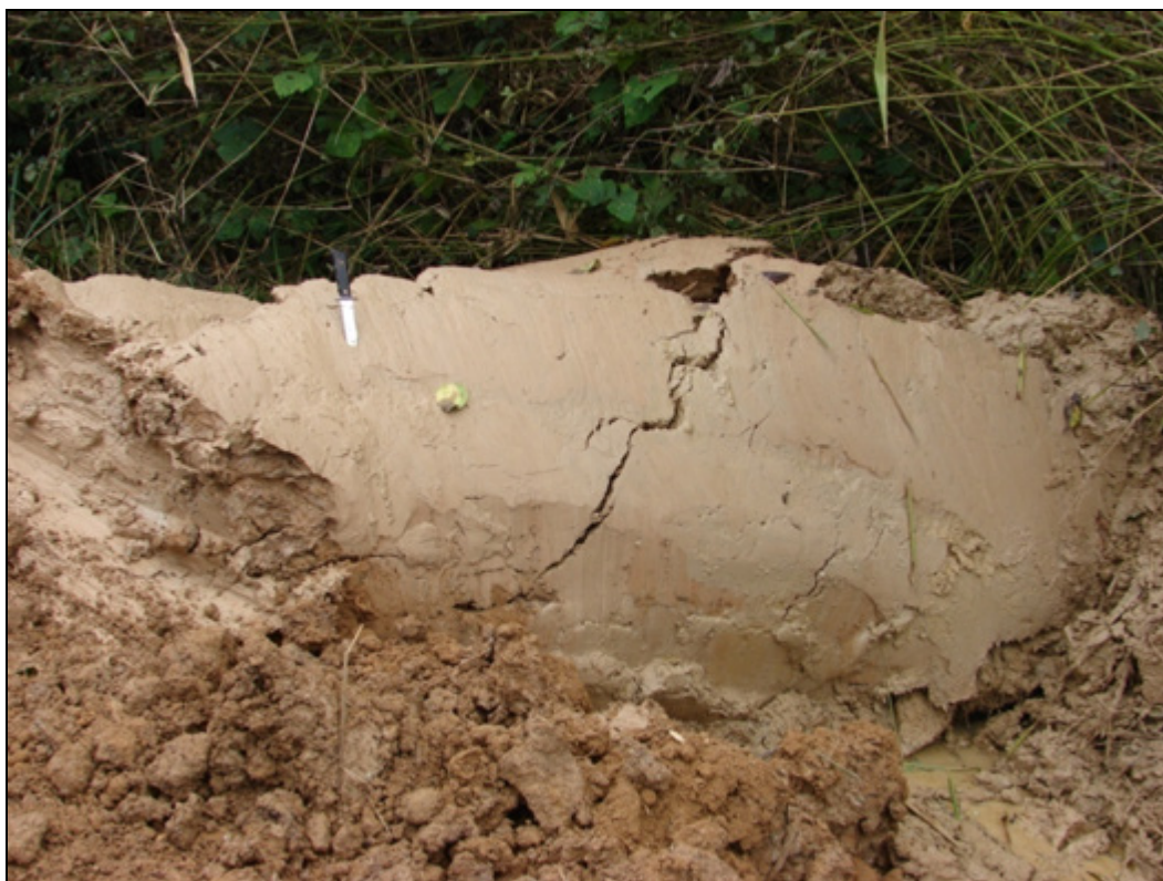
Figura 13. Detalhe de material indicador de Argila de atividade alta na unidade ambiental 3 (Cambissolos Háplico Ta Distrófico), microbacia do Igarapé Xiburema, Acre.
