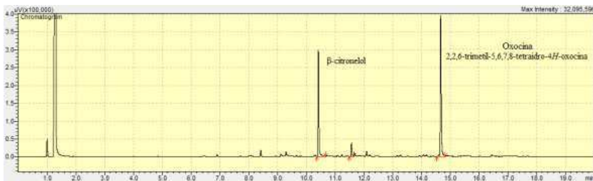
Figura 6. Cromatograma reação do \beta -citronelol com \text{Pd}(\text{OAc})_2 e \text{H}_2\text{O}_2 .
