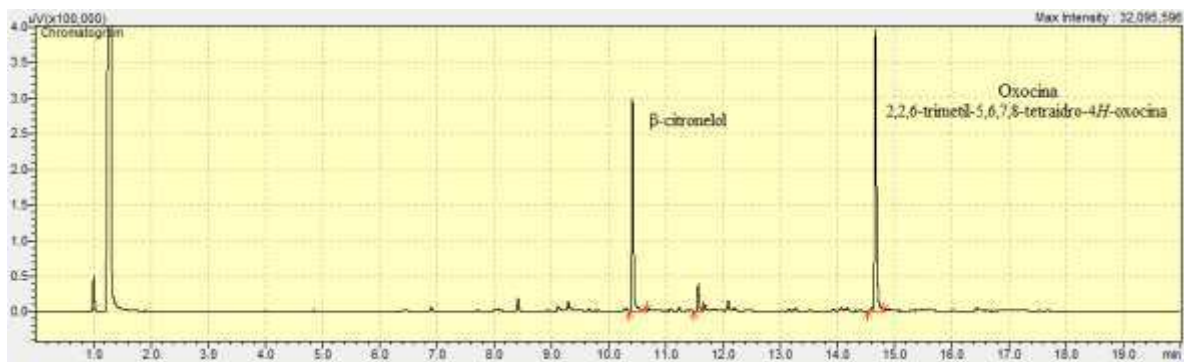
Figura 3. Cromatograma reação \beta -citronelol/ \text{H}_2\text{O}_2 / \text{Pd}(\text{OAc})_2
