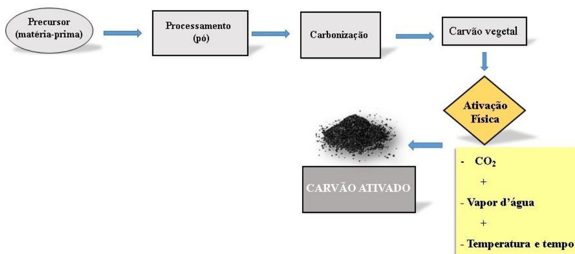
Figura 2 - Fluxograma do processo de produção dos carvões ativados fisicamente.
