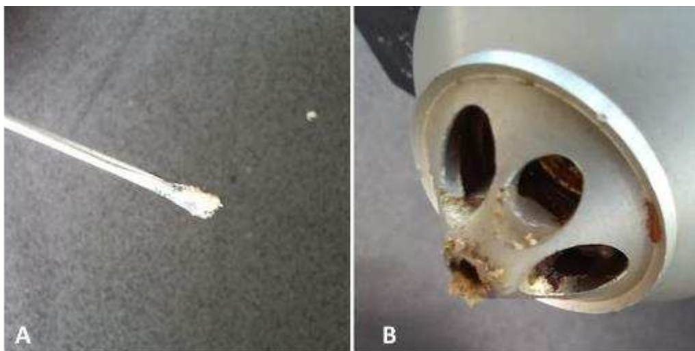
Figura 6 – Resíduo de lenho após mensuração com resistógrafo. A) Broca, B) Mandril
