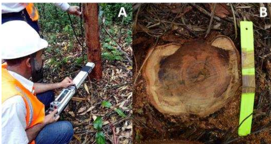
Figura 2 – Vista da operação para obtenção de dados com resistógrafo IML. A) Mensuração, B) Foto do toco após corte. O Autor (2021).
