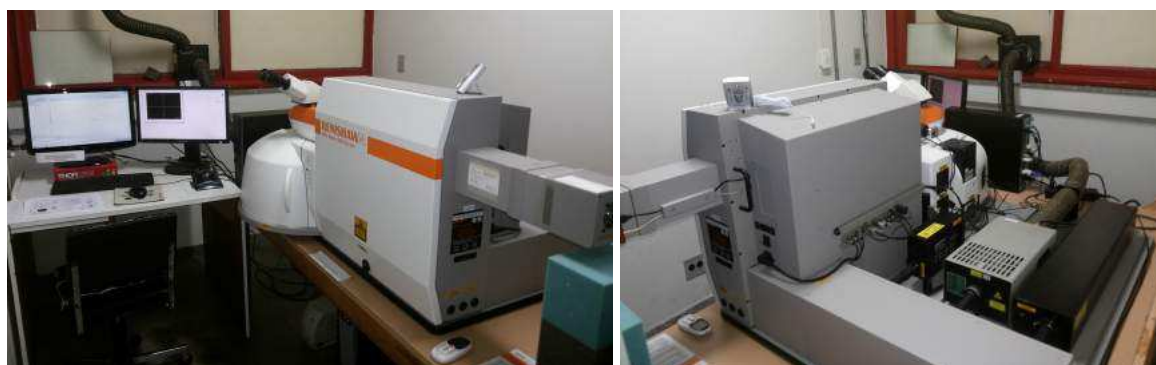
Figura 3.1: Espectrômetro Renishaw In Via micro-Raman System. Laboratório de Microscopia Raman da UFV.
