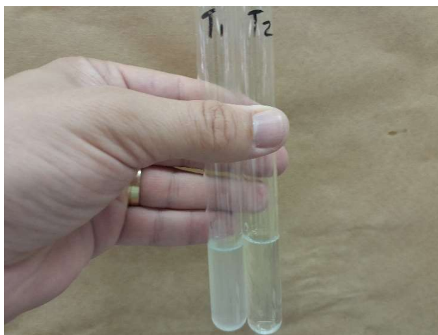
Figura 22) Após adição de sulfato de magnésio ( \text{Mg}(\text{SO}_4)_2 ) ocorre formação de precipitado na amostra de água onde estava mergulhada a membrana originária do teste 1, ou seja, da solução de carbonato de bário \text{BaCO}_3 .
