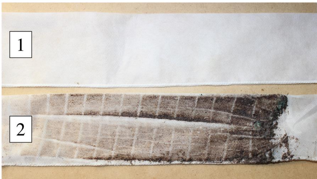
Figura 14 - Imagem 1: Filtro novo e Imagem 2: Filtro com excesso de sujeira
