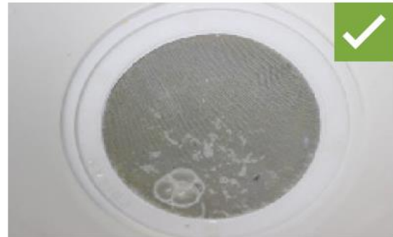
Figura 16 - Peneira de coador para sistema de ordenha balde ao pé ou manual depois da passagem do leite
