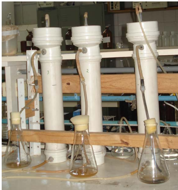
Figura 4 – Filtro anaeróbio de fluxo ascendente.
