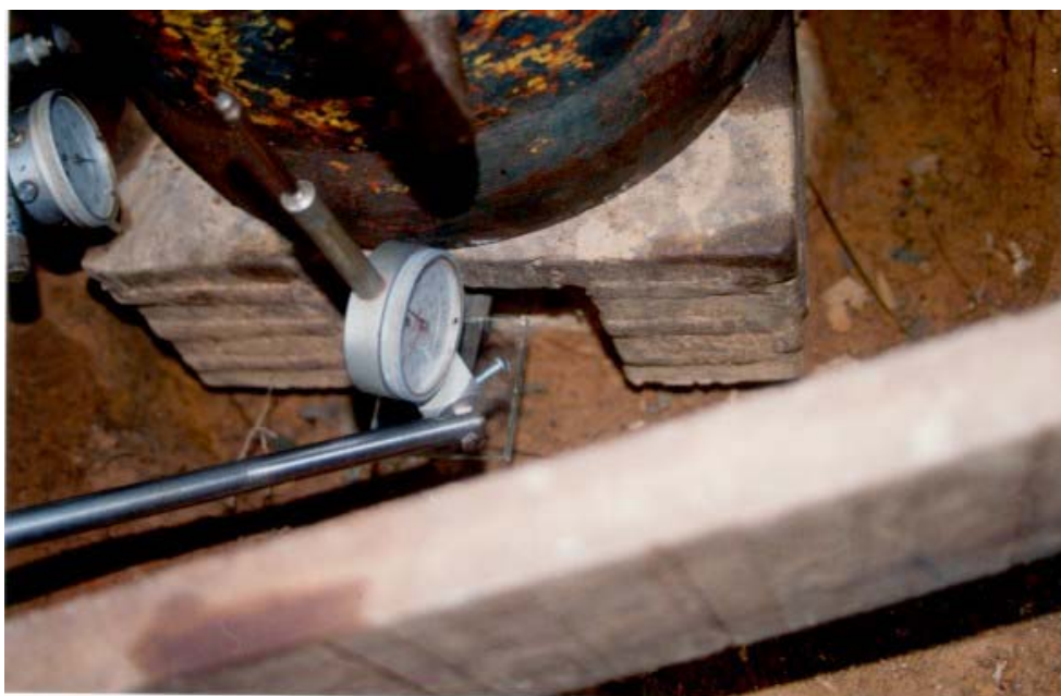
Figura 6.3 – Detalhe da placa de vidro, onde foram apoiados os extensômetros
