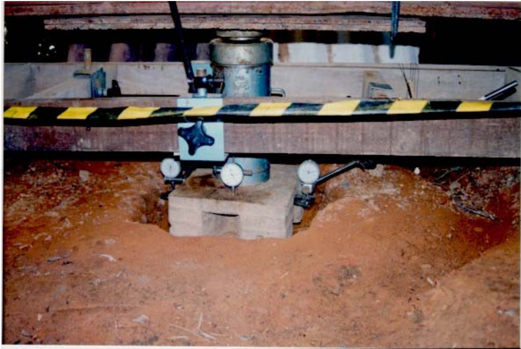
Figura 6.1 – Detalhe da montagem da prova de carga
