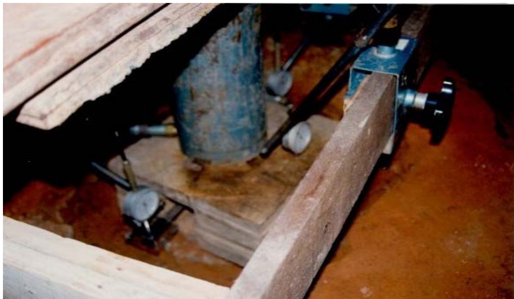
Figura 6.2 – Posicionamento dos extensômetros
