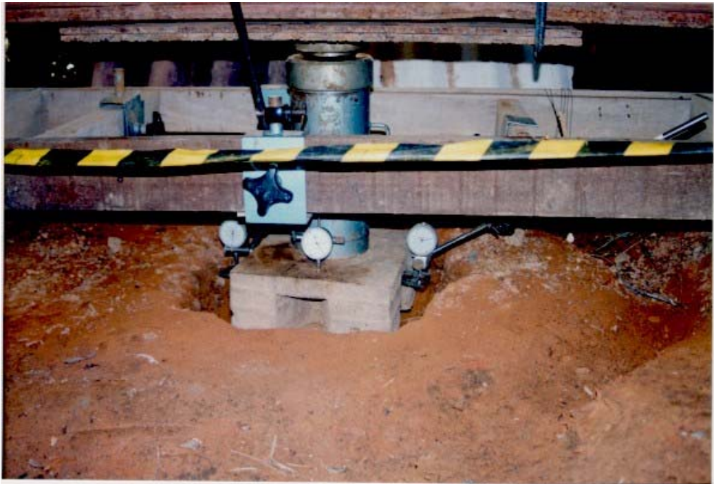
Figura 3.13 – Montagem dos extensômetros
