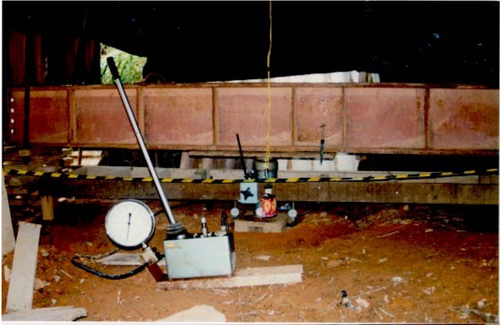
Figura 3.21 – Detalhe da bomba hidráulica e manômetro para aplicação de carga
