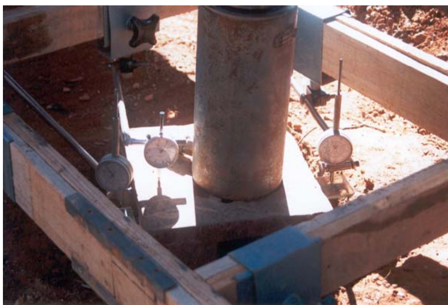
Figura 2.17 – viga de referência em madeira – Vista 02
