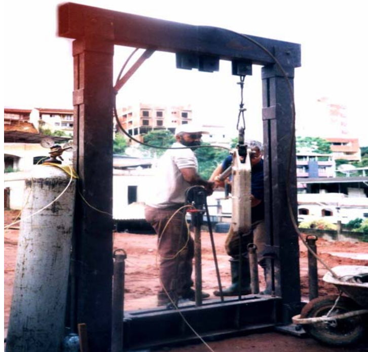
Figura 2.7 – Reação para cravação do DMT
