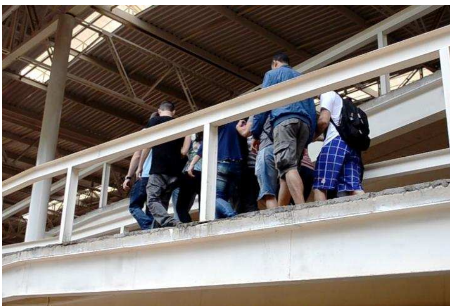
Figura 4-31 – Segundo ensaio de multidão com caminhar aglomerado.
