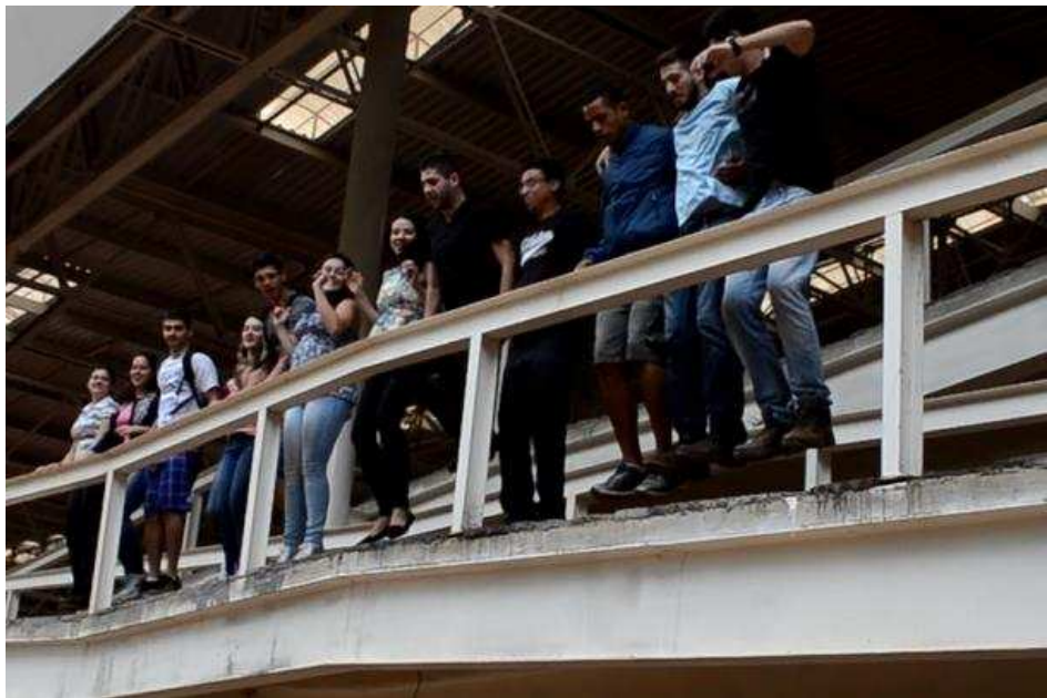
Figura 4-33 – Sexto ensaio de multidão com pulo simultâneo de voluntários na zona do Ponto P02.
