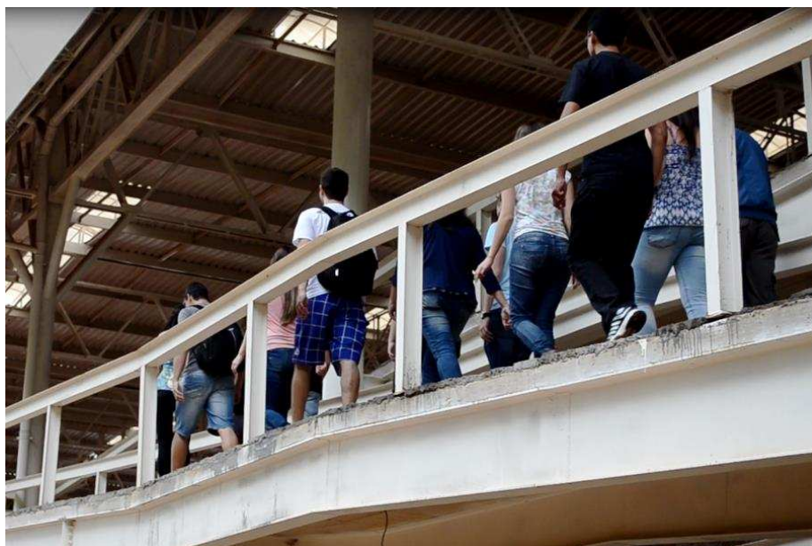
Figura 4-30- Primeiro ensaio de multidão com caminhar aleatório.
