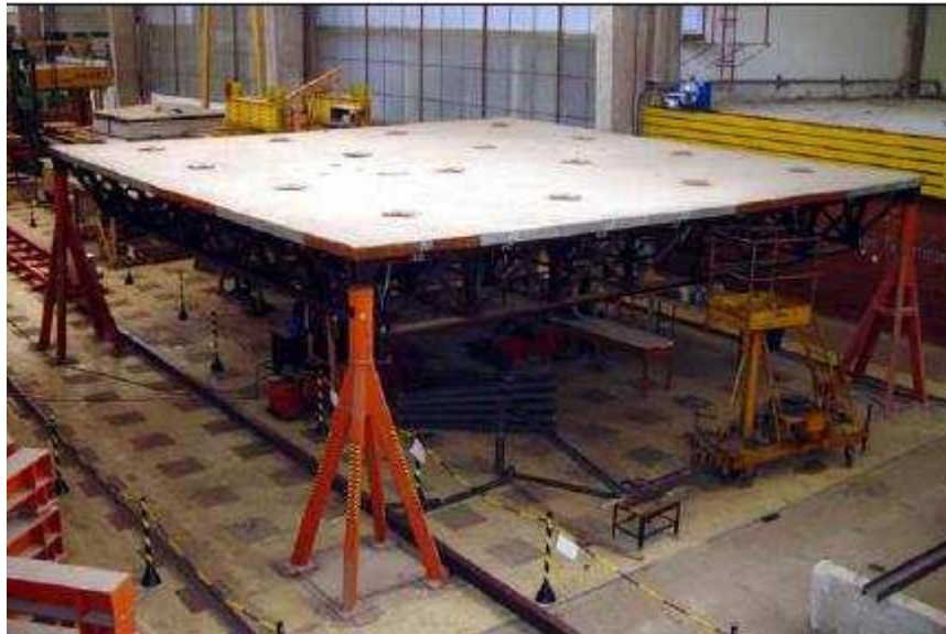
Figura 2-4 – Modelo 01 - Protótipo de estrutura reticulada espacial mista, montado no Laboratório de Estruturas da COPPE/UFRJ.
