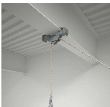
Figura 3-4 – Modelo esquemático de um ensaio de impacto com o saco de areia em um sistema de piso misto de aço e concreto.
