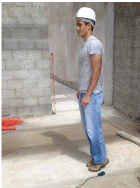
Figura 2-21 - Aspecto geral de um ensaio de impacto dos calcanhares sobre um sistema de piso.
