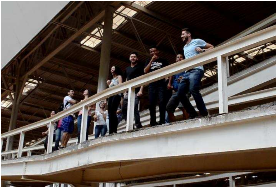
Figura 4-32 – Quinto ensaio de multidão com pulos aleatórios de voluntários na zona do Ponto P02.
