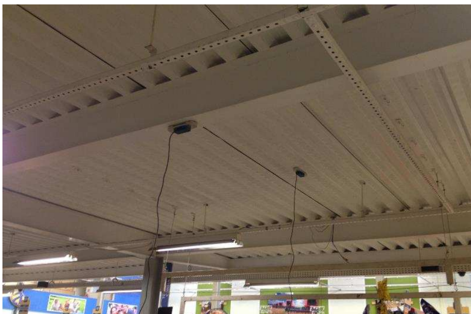
Figura 4-71 – Posicionamento dos acelerômetros nos pontos P01 - AC 1190 e P02 - AC 1169.
