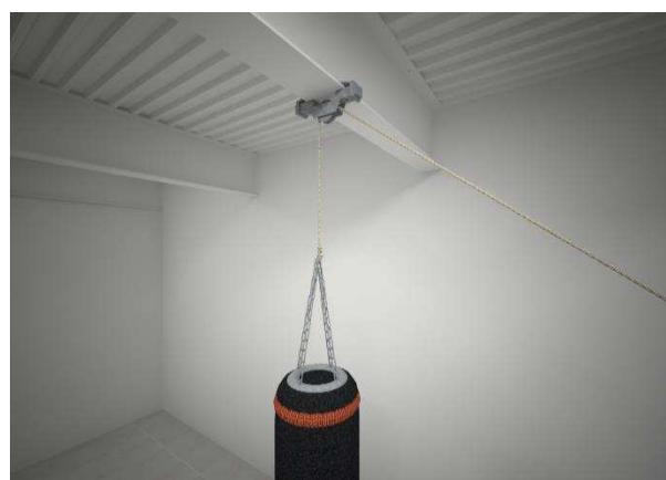
Figura 3-4 – Modelo esquemático de um ensaio de impacto com o saco de areia em um sistema de piso misto de aço e concreto.
