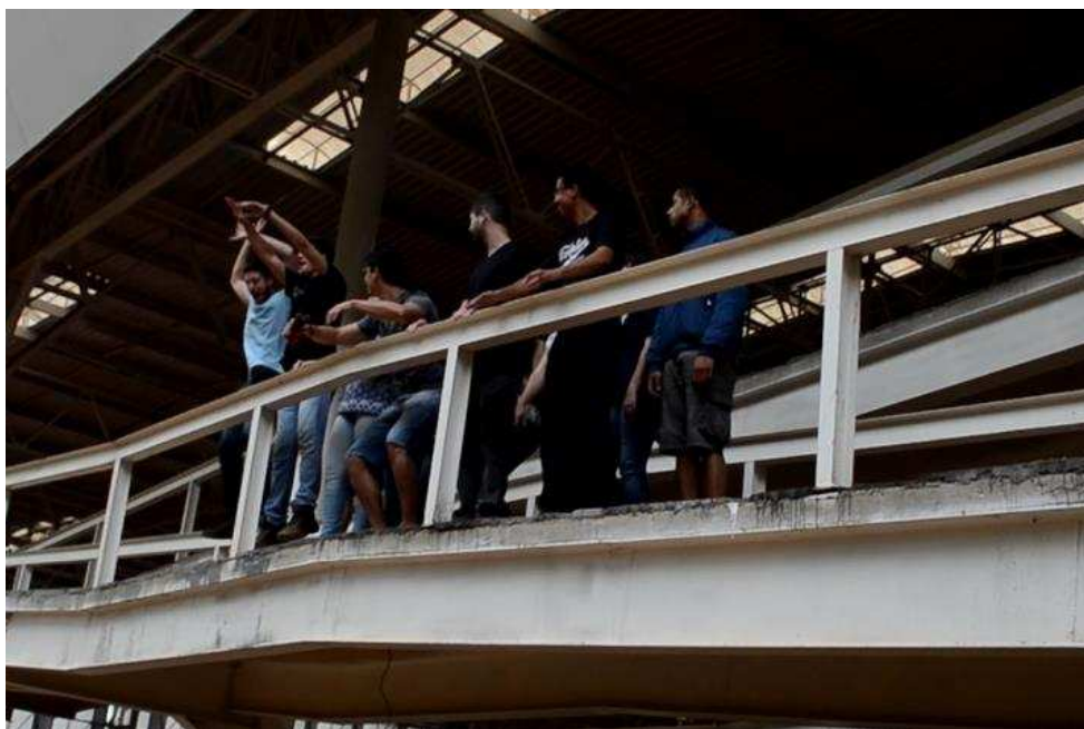
Figura 4-34 – Sétimo ensaio de multidão com pulos subsequentes de voluntários na zona do Ponto P02.
