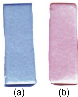
Figura 5 – Dados colorimétricos para biossensor contendo GM1 como molécula receptora para toxina da cólera: (a) filme antes da presença da toxina e (b) filme após a presença da toxina (CHARYCH et al., 1996).
