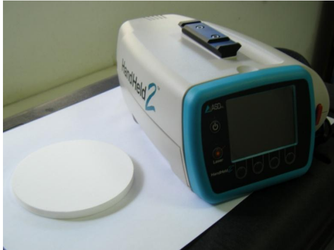
Figura 14 – Espectrorradiômetro FieldSpec® HandHeld 2™.
