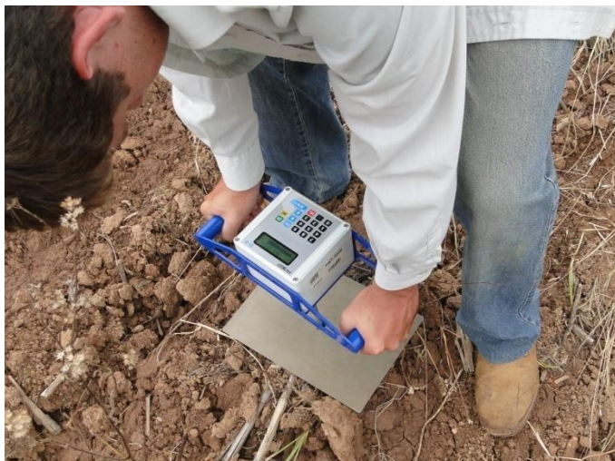
Figura 9 – Penetrômetro DLG, modelo PNT – 2000.
