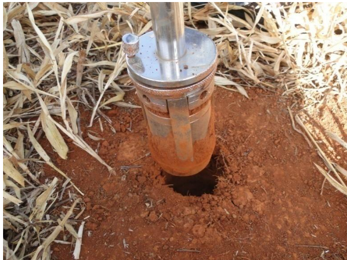
Figura 8 – Trado utilizado para coleta de amostras indeformadas.
