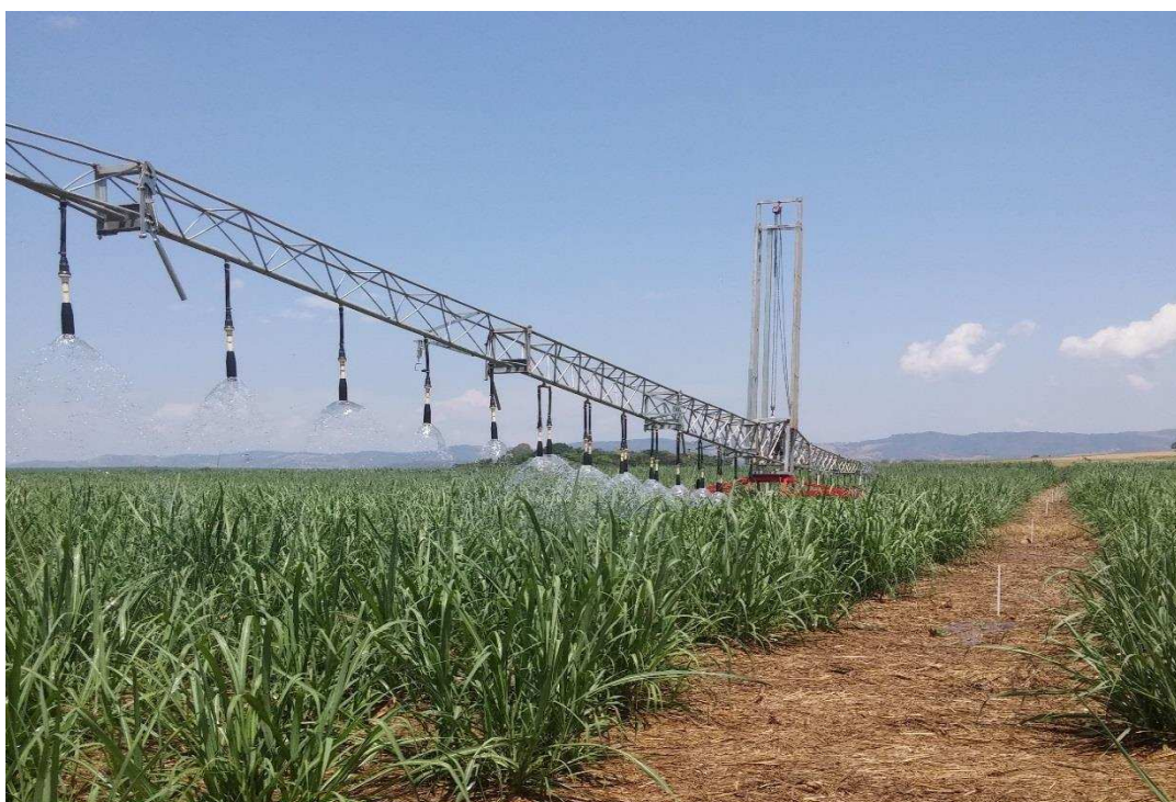
Figura 7- Barra irrigadora com emissores tipo LEPA. Fonte: Arquivo pessoal.
