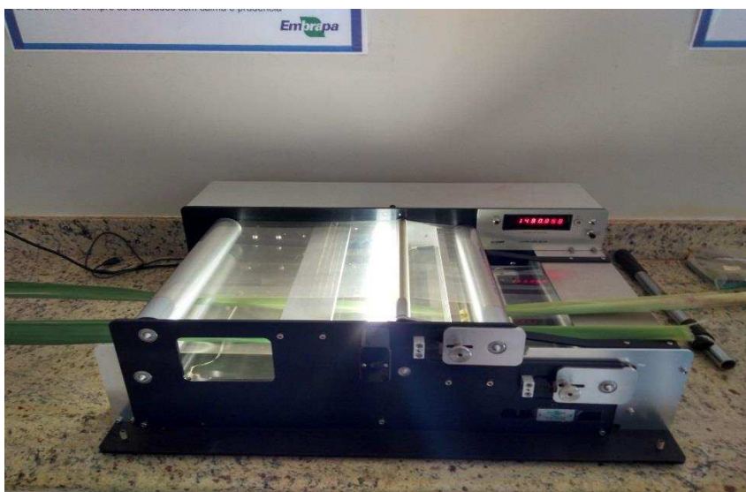
Figura 9– Medição da área foliar no integrador de área foliar (LI-COR 3100). Fonte: Arquivo pessoal.
