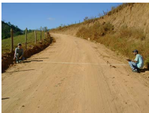
Figura 11a: Medição da plataforma da estrada vicinal VCS 296
