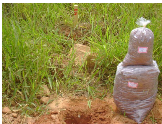
Figura 2b: Amostra deformada de solo coletada na Est. 41 + 00 da VCS 296
