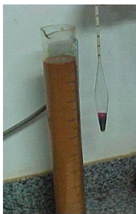
Figura 3a: Ensaio de granulometria conjunta das amostras de solos coletadas nas rodovias vicinais não pavimentadas VCS 493 e VCS 296
