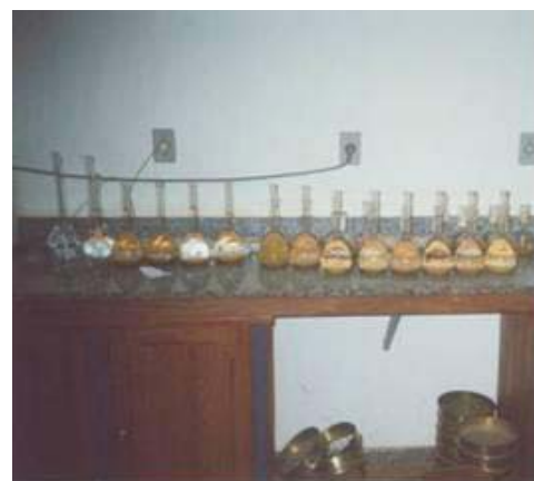
Figura 3b: Ensaio de massa específica dos grãos do solo das amostras de solos coletadas nas rodovias vicinais não pavimentadas VCS 493 e VCS 296
