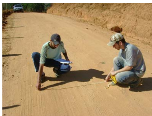
Figura 11b: Medição dos defeitos de acordo com EATON et al (1987a)
