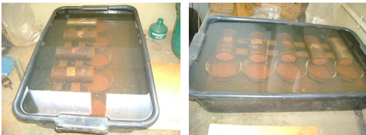
Figura 3: Ensaio de perda de massa por imersão de uma das amostras de solo coletada na VCS 346
