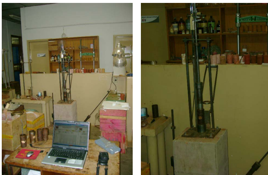
Figura 2: Ensaio de compactação Mini-MCV e moldagem de corpos-de-prova de uma das amostras de solo coletada na VCS 346
