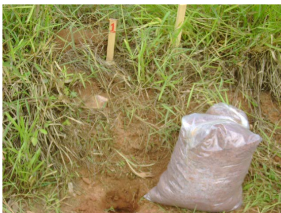
Figura 1a: Amostra deformada de solo coletada na Est. 1 + 00 da VCS 346
