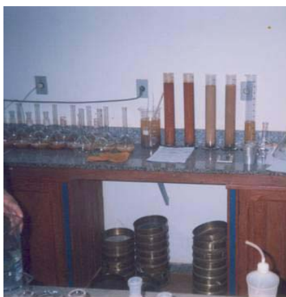
Figura 3a: Ensaio de granulometria conjunta das amostras de solos coletadas nas rodovias vicinais não pavimentadas VCS 493 e VCS 296
