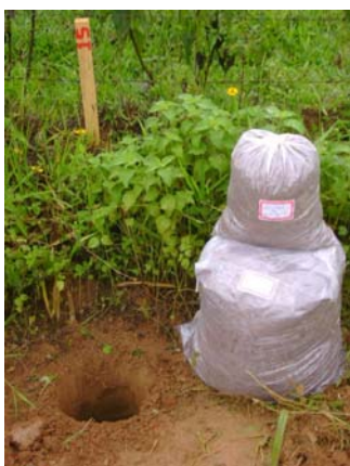
Figura 2a: Amostra deformada de solo coletada na Est. 15 + 00 da VCS 493
