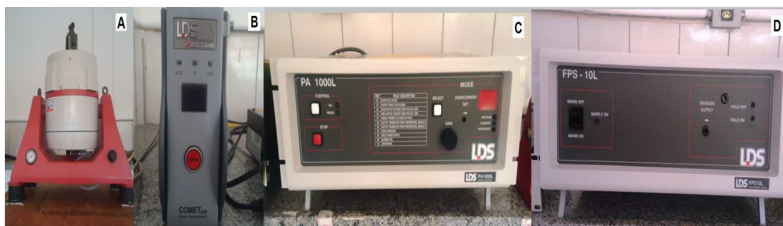
Figura 1: Equipamentos utilizados para o ensaio de vibrações mecânicas; vibrador eletromagnético (A), gerador de sinais (B), amplificador (C), fonte de alimentação (D).
