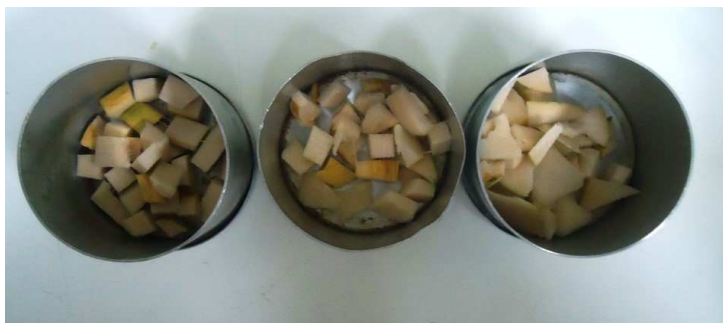
Figura 1: Cadinhos contendo amostras de ráquis de macaúba picadas com volume de 1 cm 3 .
