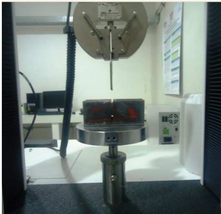
Figura 7- Configuração utilizada para o teste de cisalhamento
