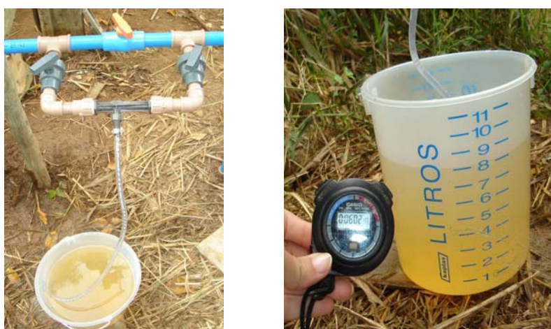
Figura 2 – Aplicação do dicloroisocianurato de sódio (65%) utilizando o injetor venturi.
