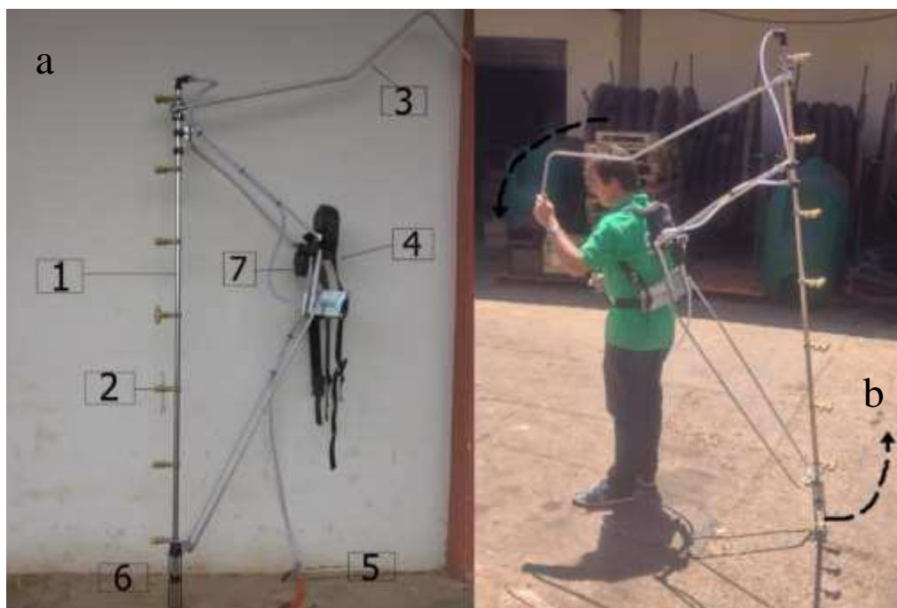
Figura 4a. Barra porta bicos (1), sessão com 2 bicos (2), alça de manobra (3), suporte de fixação com alças (4), registro (5), suporte de sustentação (6) e filtro de linha (7). Figura 4b: detalhe da acoplação do equipamento
