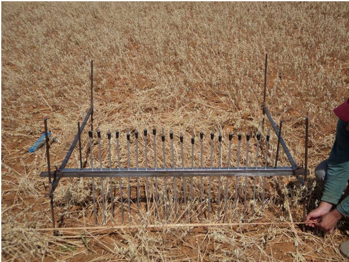
Figura 1 – Perfilômetro montado sobre duas barras corrediças
