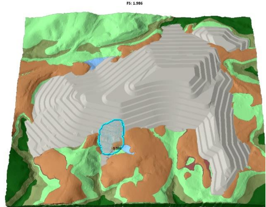
Figura 5.8 - FS 3D = 1,986 para condição normal do empilhamento compactado a 100% do Proctor Normal com parâmetro efetivo residual.
