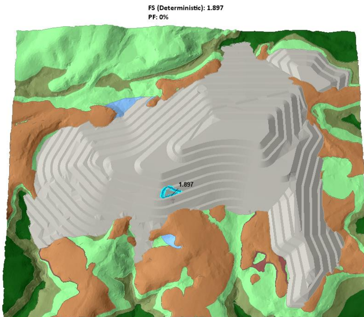
Figura 5.48 - Análise de estabilidade probabilística do empilhamento de rejeitos desaguados para saturação superficial do maciço. Fonte: O Autor.
