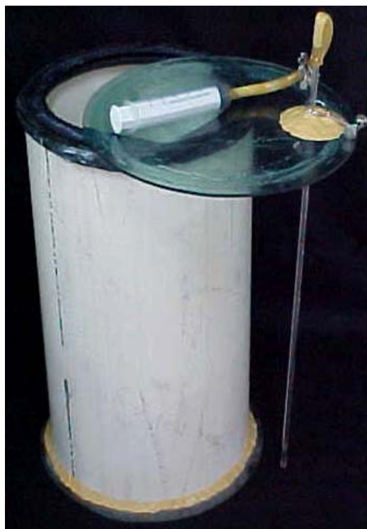
Figura 2 – Câmara de 35 L, onde as hastes de Epidendrum ibaguense foram tratadas com ethylbloc. Viçosa – Minas Gerais, 2002.
