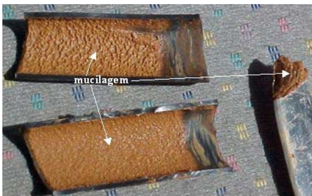
Figura 3.4 – Mucilagem formada nas paredes internas das mangueiras com detalhe de uma raspagem feita com canivete em um segmento de mangueira.
