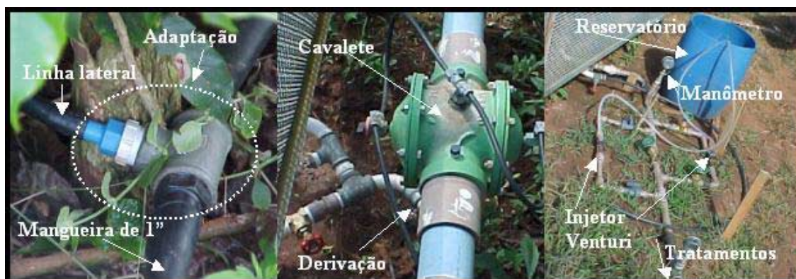
Figura 3.7 – Conexão da mangueira secundária com a linha lateral (A); derivação no cavalete de entrada de setor (B); controle de injeção após cavalete (C).
