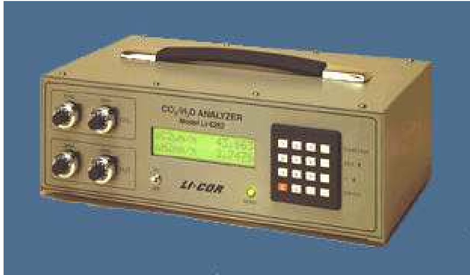
Figura 2 - Analisador de gás infravermelho - IRGA (LI-COR 6262).
