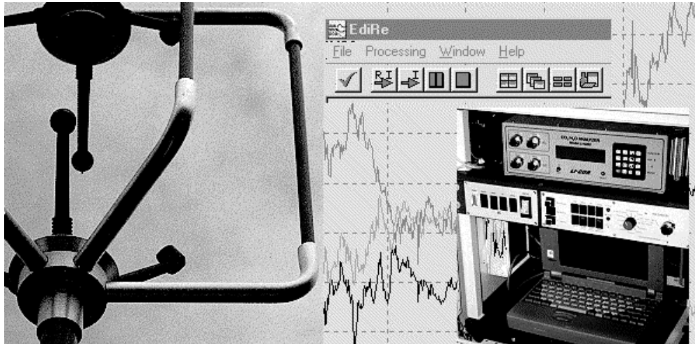
Figura 1 - Ilustração dos principais componentes do sistema de covariância de vórtices turbulentos - EdiSol.
