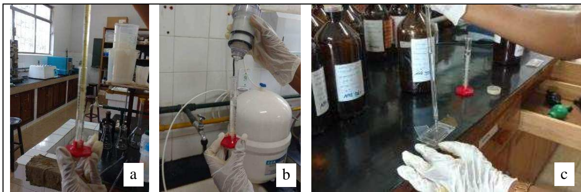
Figura 44. Diluição de amostra para análise quantitativa do fitoplâncton. Diluição a partir de 1 mL de amostra (a), volume completado para 10 mL com água destilada (b), disposição de 1 mL de amostra diluída em câmara Sedgwick-Rafter (c).
