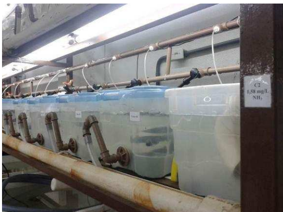
Figura 11. Disposição do sistema de recirculação para concentração 1,58 mg/L de NH 3 .
