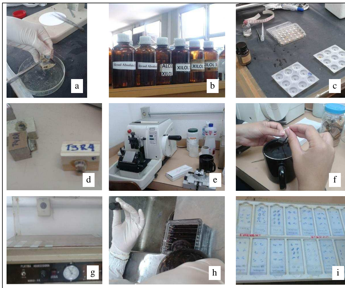
Figura 15. Fotografias da preparação do material histológico a partir das brânquias dos peixes. Extração de fragmentos de brânquias (15a), soluções para desidratação do material histológico (15b), inclusão de fragmentos em glicol-metacrilato (15c), blocos com fragmentos do material (15d), micrótomo rotativo marca Leica, modelo RM 2255 (15e), preparação de lâminas com seções semi-seriadas de 3 µm de espessura (15f, 15g), aplicação de corante nas lâminas (15h), aparência final de lâminas (15i).
