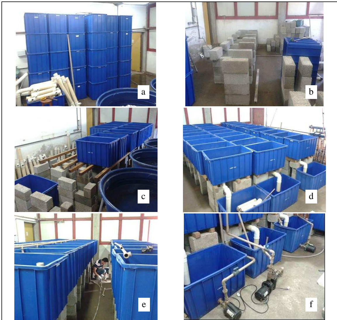
Figura 25. Fotografias da montagem do experimento para os ensaios de toxicidade crônica. Grupo de tanques para a montagem (a), suporte para as linhas de tanques em tijolos de cimento-areia (b), elementos estruturais de madeira para nivelamento e suporte dos tanques (c), sistema de drenagem do efluente das linhas de tanques e transporte para os sedimentadores (d), sistema de tubulações para distribuição de água e de ar (e), tanques para sedimentação de sólidos e sucção do líquido para recirculação (f).
