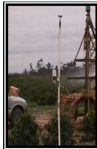
Figura 2 – Estação meteorológica automática instalada próxima ao local do teste.
