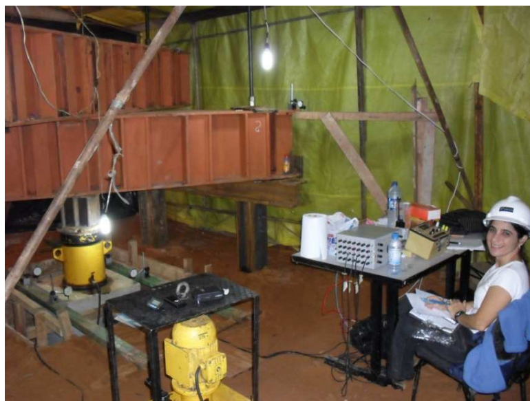
Figura 3.21 – Vista da montagem de uma prova de carga
