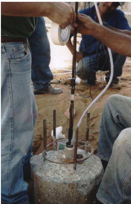
Figura 3.16 – Instalação da instrumentação no interior do tubo galvanizado
