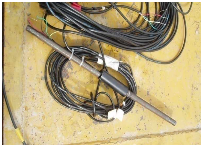
Figura 3.15 – Detalhe da proteção do strain-gage
