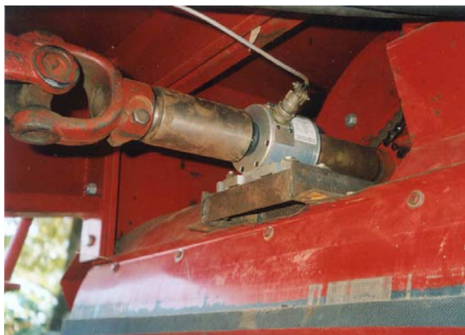
Figura 3 – Detalhe de instalação do torquímetro montado entre a árvore secundária de acionamento da colhedora e a árvore do cilindro trilhador da colhedora de feijão.
