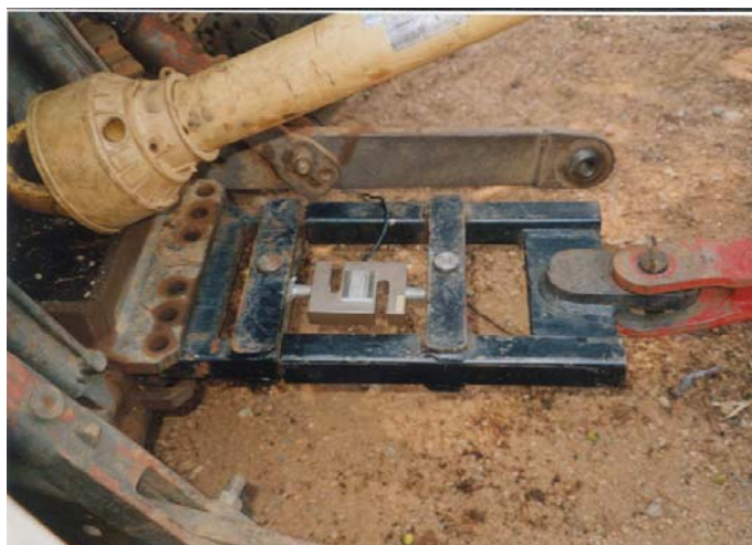
Figura 2 – Detalhe de instalação da célula de carga montada na barra de tração do trator.
