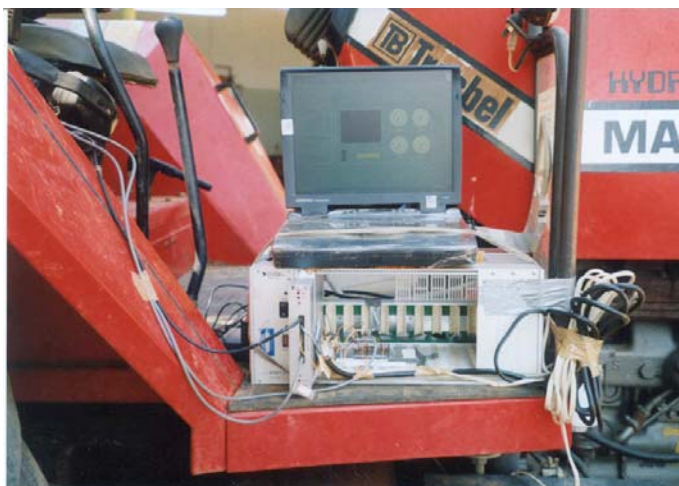
Figura 6 – Vista geral do sistema de aquisição automática de dados.
