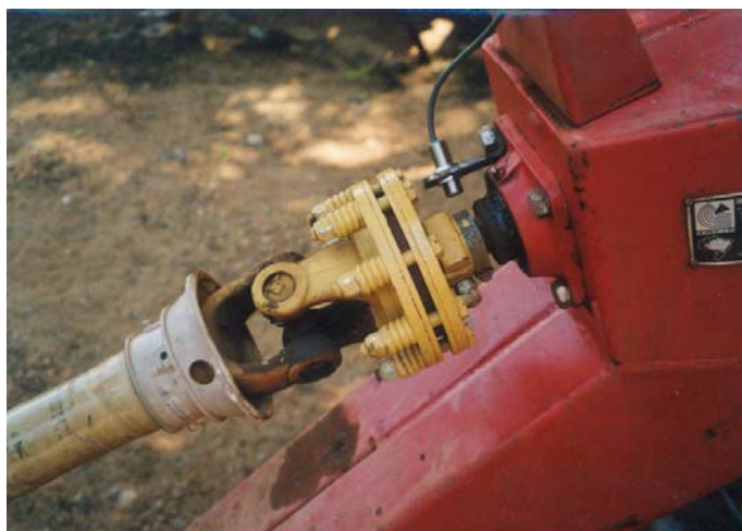
Figura 4 – Detalhe de instalação do sensor indutivo montado na árvore de acionamento primária da colhedora de feijão.
