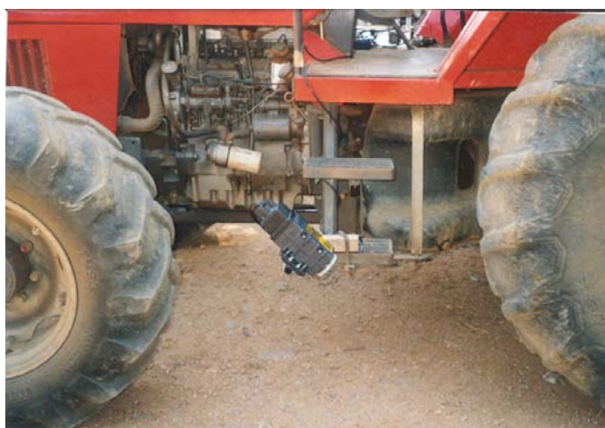
Figura 5 – Detalhe de instalação do sensor de velocidade montado na lateral do trator.
