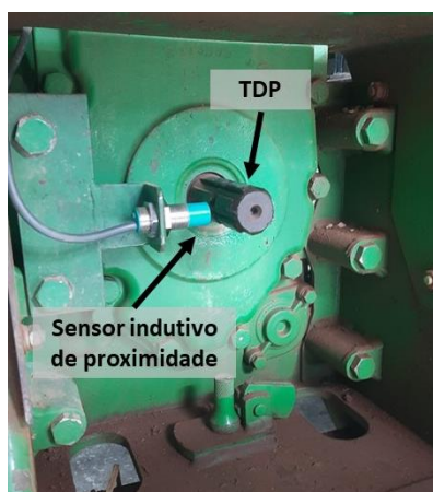
Figura 3.3 – Sensor de proximidade indutivo utilizado para medir a velocidade angular da TDP
