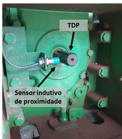
Figura 2.4 – Sensor de proximidade indutivo utilizado para medir a velocidade angular da TDP
