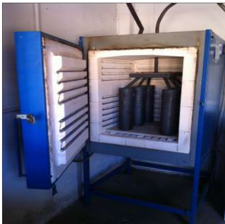
Figura 2. Forno tipo mufla utilizado para realizar a pirólise dos resíduos orgânicos.
