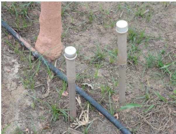
Figura 16 - Extratores instalados a profundidade de 0,20 e 0,60 m em cada parcela experimental.
