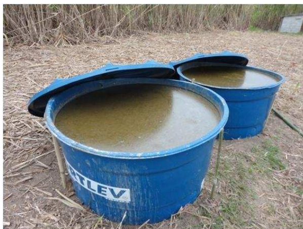
Figura 5 - Reservatórios utilizados no preparo e armazenamento da água residuária da bovinocultura de leite preparada a partir da mistura de 15% de esterco fresco da curral do SIPA e 85% de água potável
