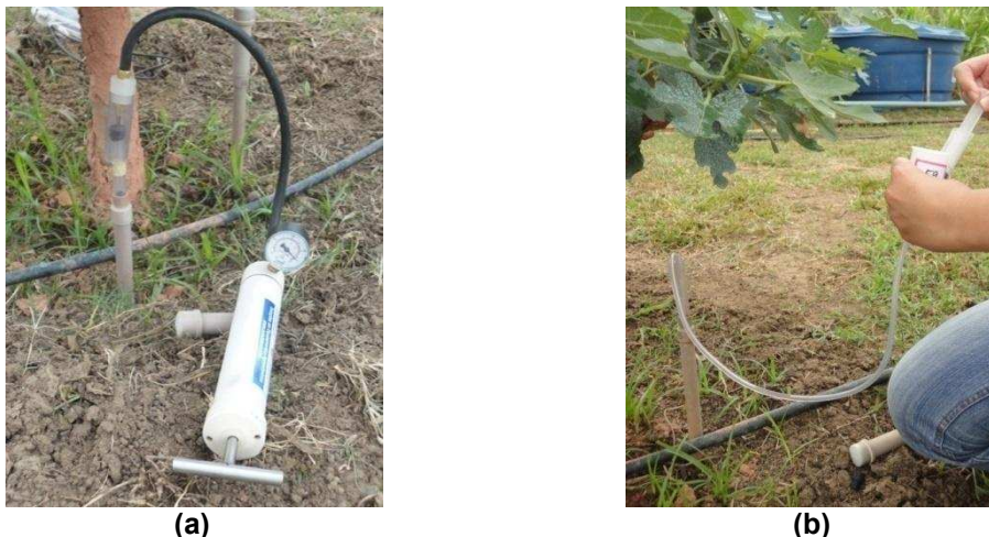
Figura 17 - Bomba manual utilizada na aplicação do vácuo (a), coleta das amostras de solução do solo (b).
