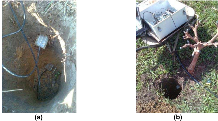
Figura 11 - Instalação (a) e teste das sondas de TDR no campo (b).
