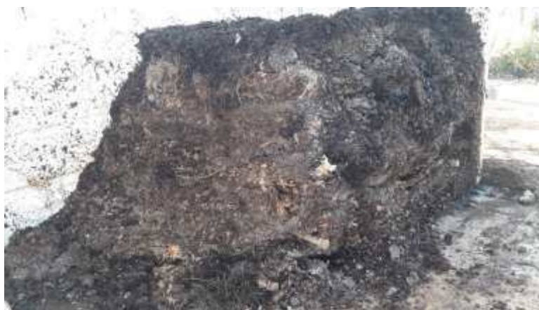
Figura 3. Vista lateral do composto durante a desmontagem do biorreator aeróbio descontínuo
