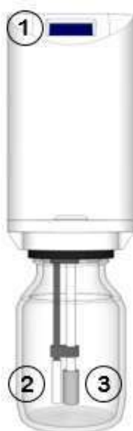
Figura 3: Equipamento portátil para medição de teor alcoólico em bebidas. Em (1) display, (2) sensor de temperatura, (3) pedra difusora de ar
