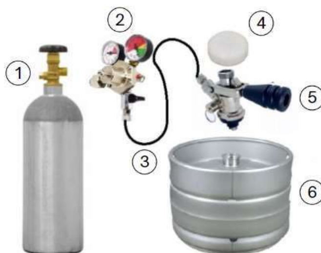
Figura 4: Equipamentos necessários para realizar a carbonatação forçada. Em (1) cilindro CO 2 , (2) válvula reguladora, (3) mangueira, (4) tampa para carbonatação, (5) válvula extratora, (6) barril de nox Fonte: Cerveja da Casa (2018)
