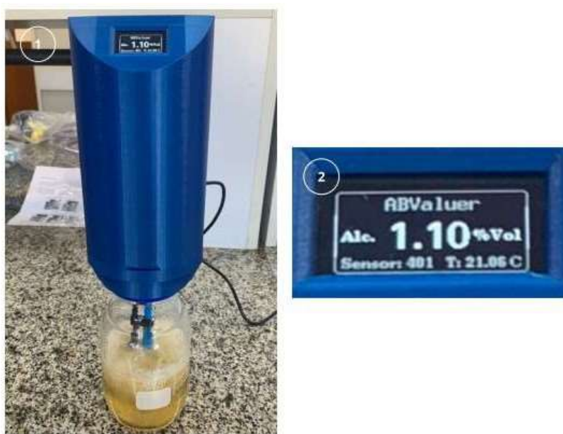
Figura 7: Amostra de kombucha analisada através do ABValuer. Em (1) equipamento no momento da medição, em (2) display ampliado com o valor de álcool expresso em %vol e temperatura em °C
