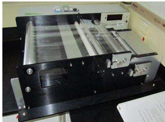
Figura 3: Coleta das amostras para medição de área foliar e matéria seca (a), integrador de área foliar Li- COR usado nas medições de área foliar (b).
