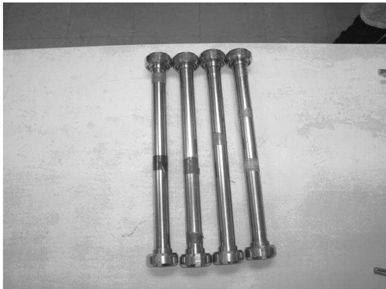
Figura 2 – Tubos de prova de aço inoxidável AISI 304 polimento nº 4, com 33 cm de comprimento e diâmetro 3,1 cm e extremidades fechadas com tampas rosqueáveis.
