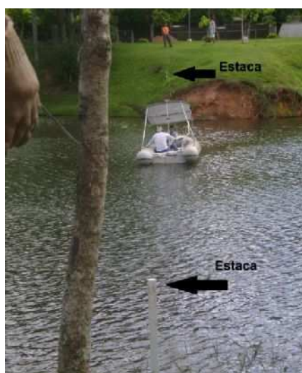
Figura 4. Foto da aquisição de uma das seções, salienta-se o alinhamento da embarcação, mantido com auxílio de cordas em ambos os lados do barco.
