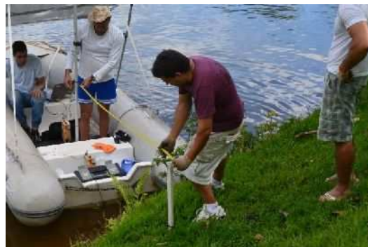
Figura 25. Medição a trena da estaca levantada pela estação total até o centro das antenas GPR.
