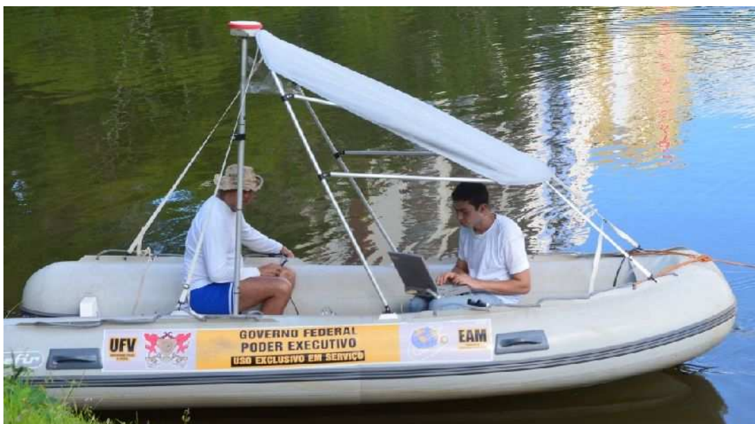
Figura 23. Aspecto da Antena do Receptor GNSS posicionada no centro das antenas GPR.
