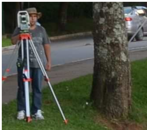
Figura 24. Levantamento com Estação Total.
