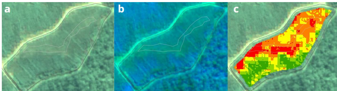
Figura 22 – Composições (a) RGB e (b) RG-NIR com falhas vetorizadas e (c) NDVI para a quadra 0212 da Fazenda C
